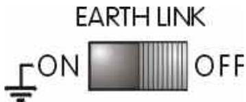
MAINS EARTH LIFTED FROM THE COMPRESSOR/NOISE GATE ELECTRIC GROUND.
