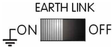
MAINS EARTH LINKED WITH THE COMPRESSOR/NOISE GATE ELECTRIC GROUND.
